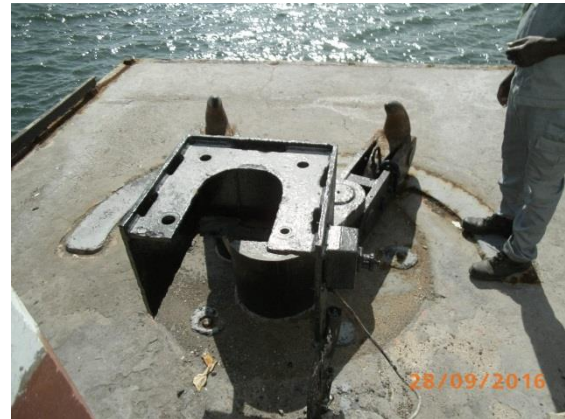
Cabestan N°1 démonté
